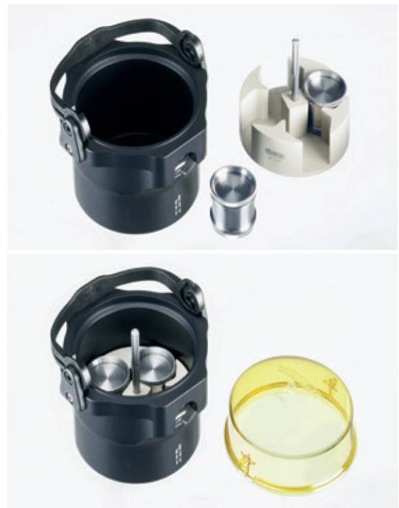
Gehänge 4780 mit Deckel 4783 und dem Spezialzubehör für die Bestimmung des Wasserrückhaltevermögens.
