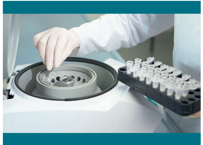
Die MIKRO 185 (Bestell-Nr. 1203) mit Spin Column Rotor (Bestell-Nr. 1213) beim Einsatz in der Probenvorbereitung für die PCR.
