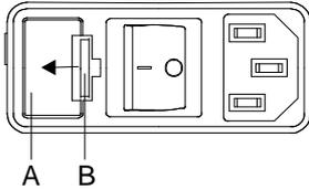
Der Sicherungshalter (A) mit den Netzeingangssicherungen befindet sich neben dem Netzschalter.
