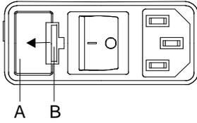
Le porte-fusible (A) avec les fusibles d'entrée de secteur se trouve à côté de l'interrupteur secteur.
