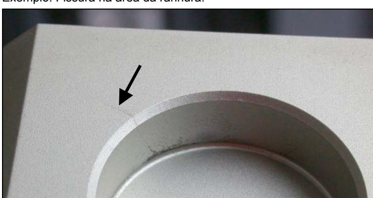
**!** Se for detectada corrosão ou desgaste no rotor e/ou no acessório, estes devem ser renovados de imediato.
