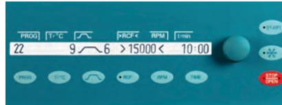
De par son confort d'utilisation, ce panneau de commande hautement développé facilite le travail quotidien dans les laboratoires. Les paramètres sont sélectionnés par l'intermédiaire des touches, les valeurs sont réglées grâce à un bouton rotatif et enregistrées en appuyant sur la touche Start. La température des centrifugeuses réfrigérées ROTINA 380 R, ROTINA 420 R, ROTANTA 460 R et ROTANTA 460 Robotic peut être réglée en degrés Celsius (°C) ou en degrés Fahrenheit (°F).
