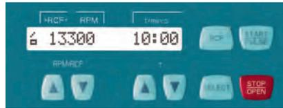
Les modèles EBA 200, EBA 200 S, HAEMATOKRIT 200 et MIKRO 185 sont équipés du panneau de configuration E Plus. Contrairement au panneau de commande E, la vitesse (RPM) ou l'accélération centrifuge relative (ACR) peuvent être réglées.
