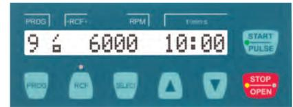
Les modèles EBA 280 et EBA 280 S sont équipés du panneau de commande M. Les paramètres sont ici sélectionnés à l'aide de la touche Select, les valeurs souhaitées sont réglées avec les touches directionnelles et enregistrées en appuyant sur la touche Start/Pulse.
