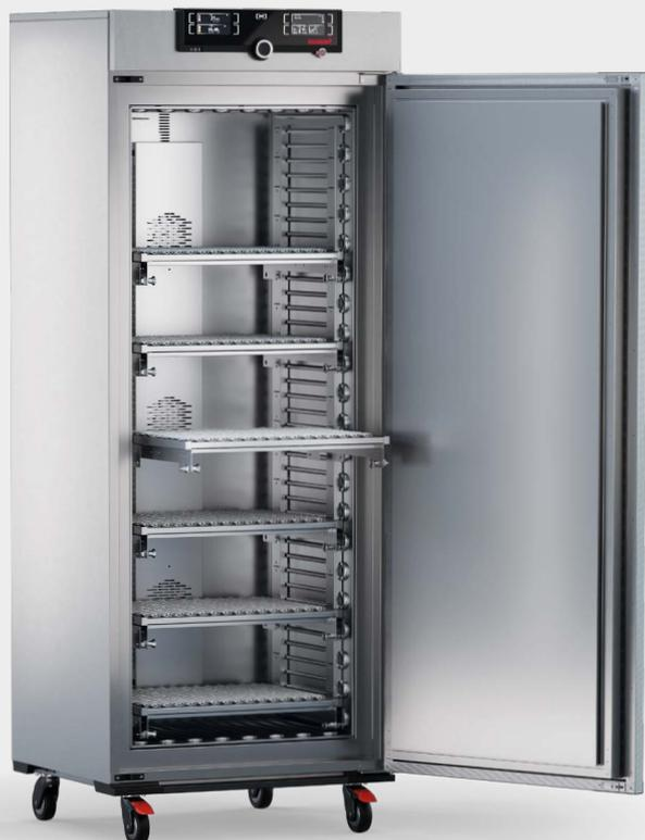
Des rails télescopiques ergonomiques et des plateaux spéciaux facilitent le chargement de l'appareil.
