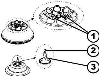
Fig. 15: Montarea-demontarea rotorului
