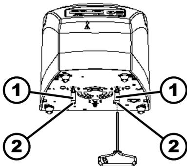
Рис. 13: Транспортировочное крепление
