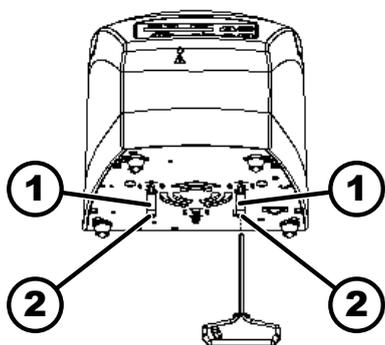
Рис. 14: Транспортировочное крепление
