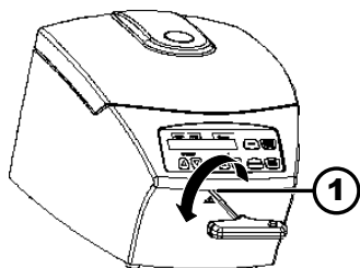
Фиг. 16: Аварийно деблокиране
