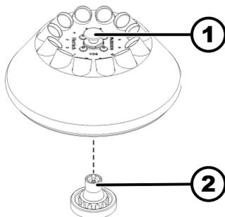
Fig. 18: Montarea-demontarea rotorului
