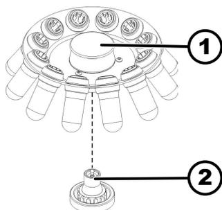
Fig. 19: Montarea-demontarea rotorului
