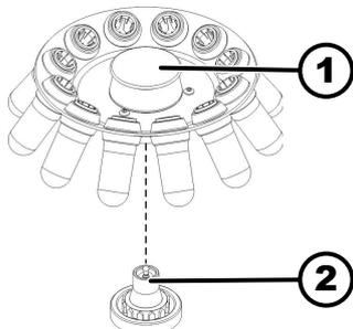
Фиг. 19: Монтаж-демонтаж на ротора
