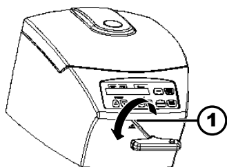
Slika 16: Otključavanje poklopca u slučaju nužde
