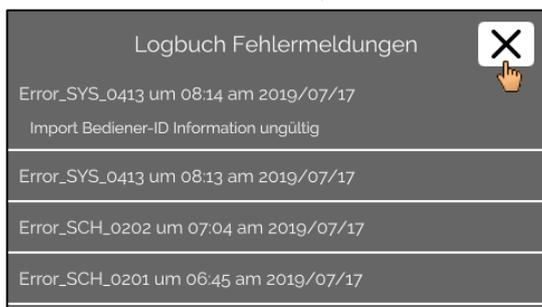
Durch Antippen des Symbols "X", rechts oben im Screen, wird das Fehler Logbuch geschlossen.
