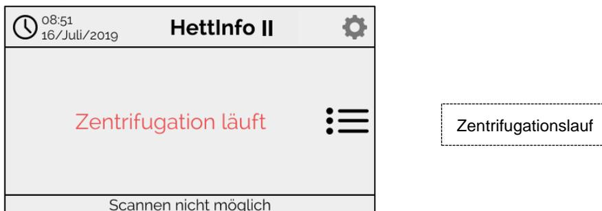
Während des Zentrifugationslaufes können keine weiteren Daten eingescannt werden. Die Prozess-Daten können während des Zentrifugationslaufes über die Detailansicht angezeigt werden.
