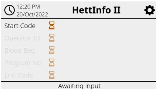
Una volta che la scansione del codice avvio è riuscita, il simbolo della clessidra si trasformerà in un segno di spunta verde.
