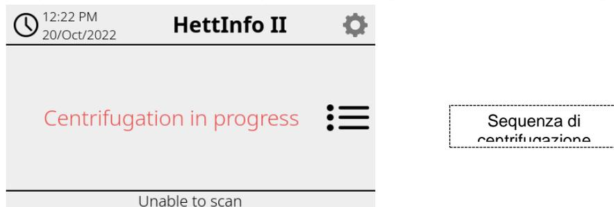
Durante la sequenza di centrifugazione non possono essere scansionati dati aggiuntivi. I dati di elaborazione possono essere visualizzati durante la sequenza di centrifugazione mediante la videata dettagliata. In questo modo è possibile riesaminare la sacca sangue correntemente centrifugata, il programma usato e chi ha eseguito la scansione.
