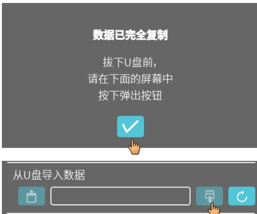
数据导入完成后，将显示相应消息，必须通过单击复选标记予以确认。之后，将返回导入屏幕。可通过在按下“卸载”按钮后将 U 盘从系统中断开，安全地拔下 U 盘。
