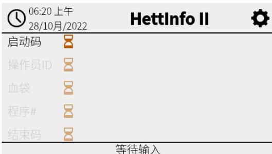
成功扫描启动码后，“沙漏符号”将变成一个绿色复选标记。
