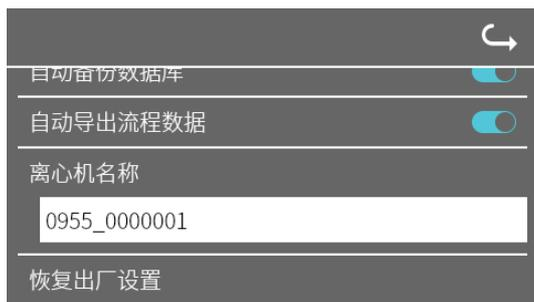
离心机名称可以更改。最少 1 个字符，最多 60 个字符。使用的字符仅限于英文字母 (a-z, A-Z)、数字 (0-9) 和特殊字符 "\_" 和 "-"。
