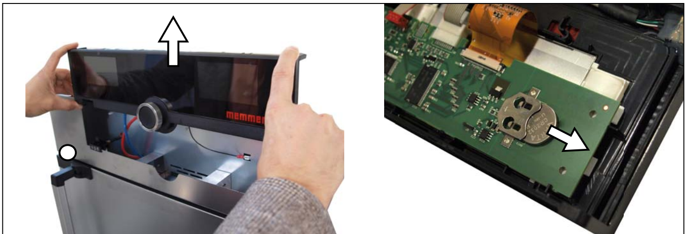
Ill. 32 Retirer la batterie lithium
