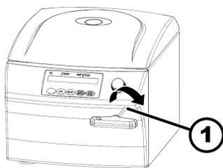
Рис. 18: Аварийная разблокировка
