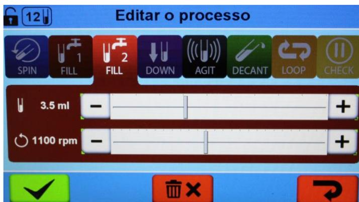
Encher com uma solução secundária diretamente nos tubos através do distribuidor do rotor em rotação.
