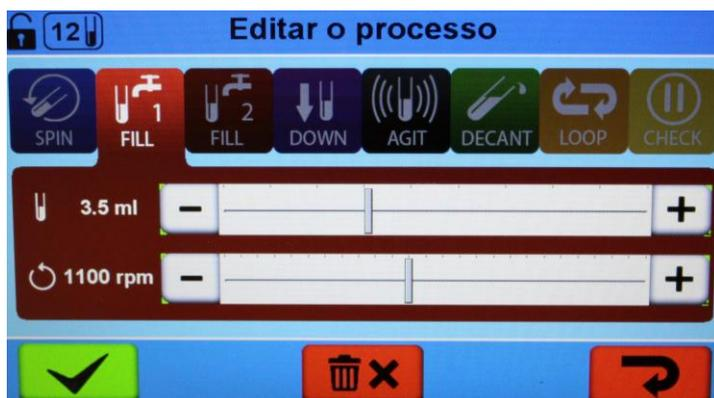
Encher com soro fisiológico diretamente nos tubos através do distribuidor do rotor em rotação para obter uma boa ressuspensão das células. Para isso, está disponível um intervalo de rotações entre 0 rpm e 2500 rpm. O volume de enchimento que pode ser definido por tubo é entre 0,1 ml e 10 ml. O valor standard é de 3,5 ml a 1100 rpm.
