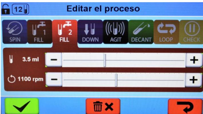
Llenar una solución secundaria directamente en los tubos a través del distribuidor del rotor giratorio. Para ello, se dispone de una gama de velocidades que va de 0 rpm a 2500 rpm. El volumen de llenado que se puede ajustar por tubo oscila entre 0,1 ml y 10 ml. El valor predeterminado es de 3,5 ml a 1100 rpm.
