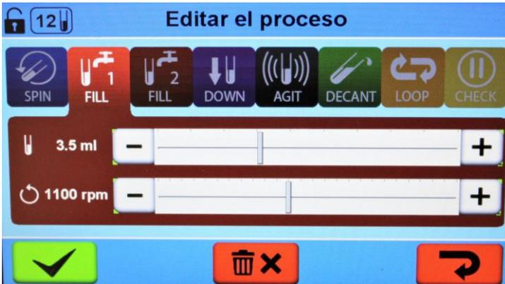
Llenar la solución salina fisiológica directamente en los tubos a través del distribuidor del rotor giratorio para obtener una buena resuspensión de las células. Para ello, se dispone de una gama de velocidades que va de 0 rpm a 2500 rpm. El volumen de llenado que se puede ajustar por tubo oscila entre 0,1 ml y 10 ml. El valor predeterminado es de 3,5 ml a 1100rpm.
