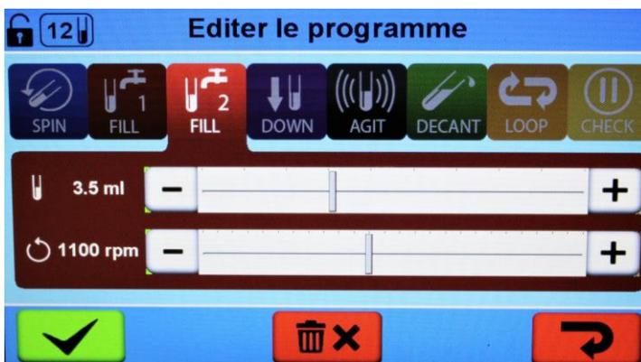
Introduction d'une solution secondaire directement dans les tubes via le distributeur du rotor tournant. Une plage de vitesse de rotation de 0 tr/min à 2500 tr/min est disponible à cet effet. Le volume de remplissage à régler par tube est compris entre 0,1 ml et 10 ml. La valeur par défaut est de 3,5 ml à 1100 tr/min.
