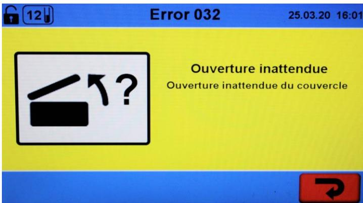
En cas de panne de courant, le couvercle ne peut pas être ouvert. Un déverrouillage d'urgence doit être effectué manuellement.
