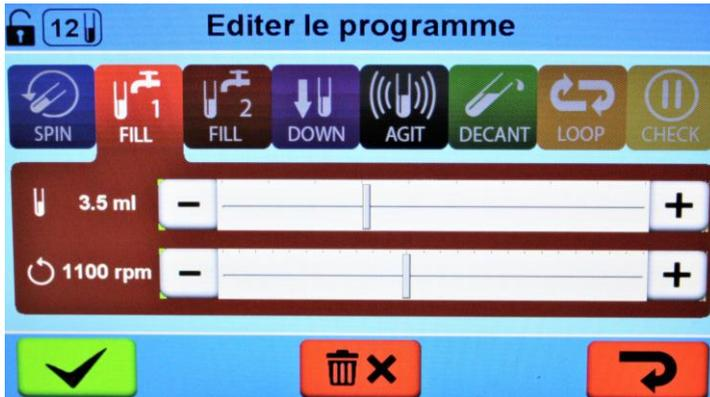
Introduction de la solution saline physiologique directement dans les tubes via le distributeur du rotor rotatif afin d'obtenir une bonne remise en suspension des cellules. Une plage de vitesse de rotation de 0 tr/min à 2500 tr/min est disponible à cet effet. Le volume de remplissage à régler par tube est compris entre 0,1 ml et 10 ml. La valeur par défaut est de 3,5 ml à 1100 tr/min.
