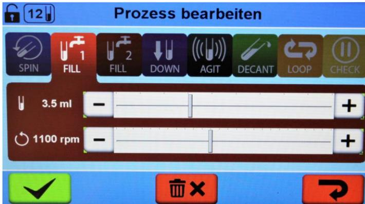
Einfüllen der physiologischen Kochsalzlösung direkt in die Röhrchen über den Verteiler des drehenden Rotors, um eine gute Resuspension der Zellen zu erhalten. Hierfür steht ein Drehzahlbereich von 0 rpm bis 2500 rpm zur Verfügung. Das einzustellende Füllvolumen pro Röhrchen beträgt zwischen 0,1 ml und 10 ml. Der Standardwert beträgt 3.5 ml bei 1100rpm.
