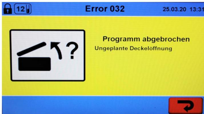
Bei einem Netzausfall kann der Deckel nicht geöffnet werden. Es muss eine Notentriegelung von Hand durchgeführt werden.
