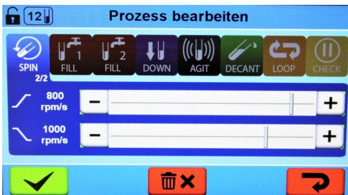
Der Standardwert für die Beschleunigung beträgt 800 rpm/s.
