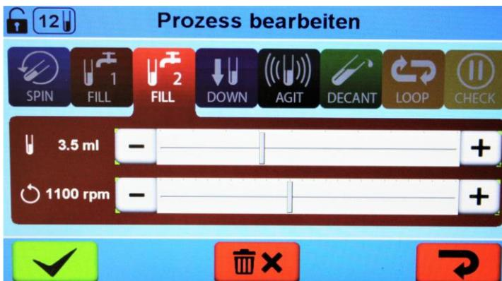
Einfüllen einer sekundären Lösung direkt in die Röhrchen über den Verteiler des drehenden Rotors. Hierfür steht ein Drehzahlbereich von 0 rpm bis 2500 rpm zur Verfügung. Das einzustellende Füllvolumen pro Röhrchen beträgt zwischen 0,1 ml und 10 ml. Der Standardwert beträgt 3.5 ml bei 1100rpm.
